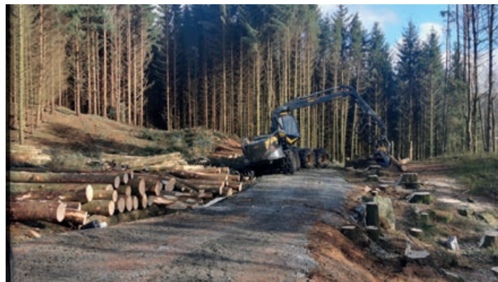
Ponsse Scorpion King hoggstmaskin. Kan felle trær med diameter opp til 70cm.
